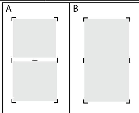
Quando le due zone di cottura separate sono mostrate nella figura B, la luce di separazione dovrebbe spegnersi. Quando l'ampia superficie di cottura viene nuovamente separata in due zone di cottura separate, la luce di separazione dovrebbe essere illuminata.
