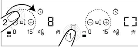
3. Toccando l'area di regolazione o facendo scorrere il dito sull'area, regolare il livello di temperatura tra "0" e "15".
