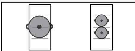
**Livelli 15 (Frittura):** Posizionando la padella sulle due zone di cottura anteriori sulle zone di cottura destra e sinistra, il piano di cottura funzionerà al livello 15.
