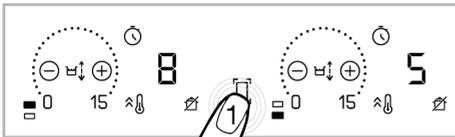
1. Toccare il tasto di selezione della zona di cottura grande mentre una o entrambe le zone di cottura è/sono in funzione.
