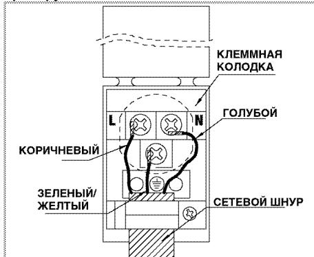
**2. Инструкция по подключению к однофазной электрической сети**
