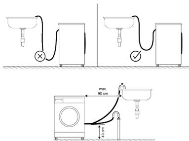
2. Conecte la manguera a una altura mínima de 40 cm y máxima de 90 cm.
