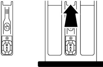
1. Presione la parte marcada del sifón dentro del compartimento del suavizante y luego tire del cajón hacia usted para sacarlo.
