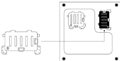
Apoye las lengüetas de la cubierta B contra el panel inferior. Complete el montaje girando la tapa.
