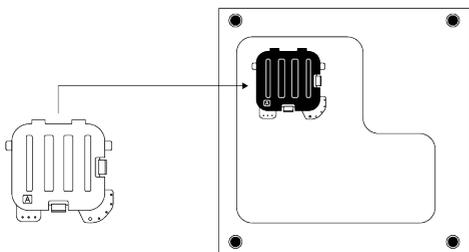
Incline la máquina ligeramente hacia atrás. Apoye las lengüetas de la cubierta A contra el panel inferior. Complete el montaje girando la tapa.
