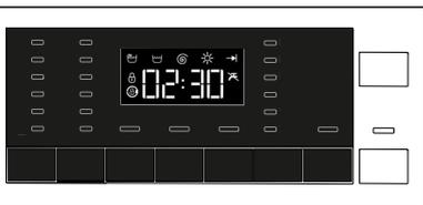
Si el nivel de agua en el interior de la máquina permite que se abra la puerta cuando pulse el botón **Inicio/ Pausa**, la luz de "Apert. puerta». se apagará. Si el nivel de agua en la máquina no es el adecuado cuando pulse el botón **Inicio/ Pausa**, la pantalla informará de que la puerta de carga está bloqueada.
