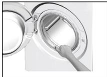
Tras cada lavado, asegúrese de que no queden sustancias extrañas en el tambor. Si se obstruyen los orificios del fuelle que se muestran en la figura, ábralos con un palillo.
