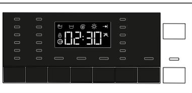
La puerta de carga dispone de un sistema de bloqueo que evita que la puerta se abra cuando el nivel de agua en el tambor desaconseje su apertura. La luz "puerta bloqueada" del panel se enciende cuando la puerta de carga está bloqueada.
