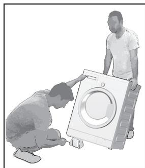
Incline la lavadora hacia atrás para retirar estos refuerzos. Retire los refuerzos de embalaje adjuntos a la cinta.
