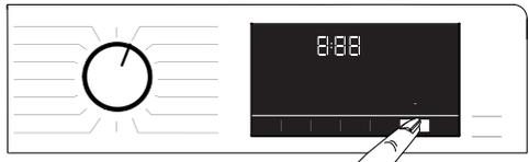
Mit der **Endzeit**-Funktion können Sie den Beginn des Waschvorgangs um bis zu 24 Stunden hinausschieben. Nach Betätigen der **Endzeit**-Taste entspricht die angezeigte Zeit der geschätzten Endzeit des Programms. Falls eine **Endzeit** eingestellt ist, leuchtet die Endzeit-Anzeige auf.
