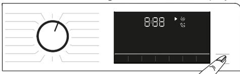
Falls der Wasserstand in der Maschine bei Betätigung der **Start/Pause**-Taste zu hoch ist, zeigt das Display an, dass die Gerätetür verriegelt ist.
