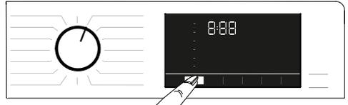
Sobald Sie ein neues Programm auswählen, wird die für das ausgewählte Programm empfohlene **Schleuderdrehzahl** angezeigt.
