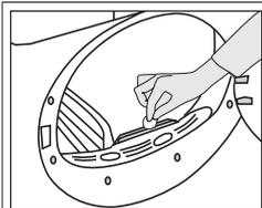
Hay sensores de humedad en la secadora que detectan si la ropa está seca o no. Para limpiar los sensores:
