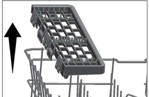
Si desea volver a utilizar la rejilla del cesto del estante de servicio multipropósito, puede engancharlo fácilmente en la sección lateral del cesto superior.
