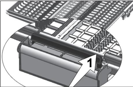
En modelos con la característica de movimiento parcial, presionando la barra (1) en el asa permite que la bandeja central de la cesta acceda a la posición inferior y el sistema se desbloquee. Así se pueden utilizar las bandejas laterales derechas e izquierdas como partes móviles. El espacio libre habilitado por las bandejas laterales permite la carga de piezas largas en la cesta superior.
