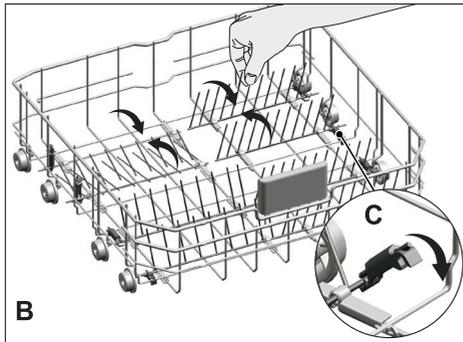
**i** Puede que las púas se doblen si las coge de los extremos. Por lo tanto, será necesario poner las púas del medio en posición vertical y horizontal cogiéndolas del tronco y pulsándolas en la dirección de la flecha.
