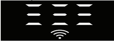
El indicador de conexión Wi-Fi se ilumina de forma constante si la conexión inalámbrica está activada, y parpadea a intervalos cortos si la conexión inalámbrica está desactivada. Si pulsa el botón del mando a distancia mientras la función está activada, la función HomeWhiz se desactiva, el indicador del producto muestra el tiempo de retraso/tiempo de programa. Led de botón HomeWhiz se apaga en la posición de apagado.
