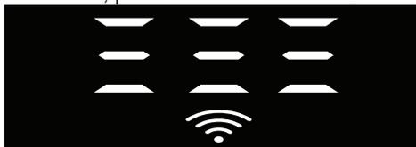
El indicador de conexión Wi-Fi se ilumina de forma constante si la conexión inalámbrica está activada, y parpadea a intervalos cortos si la conexión inalámbrica está desactivada.
