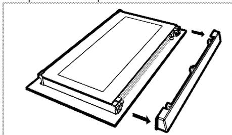
3. Levante ligeramente el panel de vidrio más interno (1) en la dirección **A** y extráigalo tirando de él en la dirección **B**, tal y como se muestra en la ilustración.
