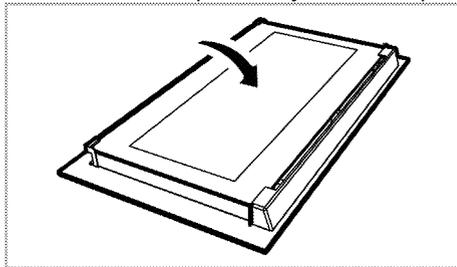
2. Потягніть на себе та витягніть пластмасову накладку, встановлену у верхній секції передніх дверцят.
