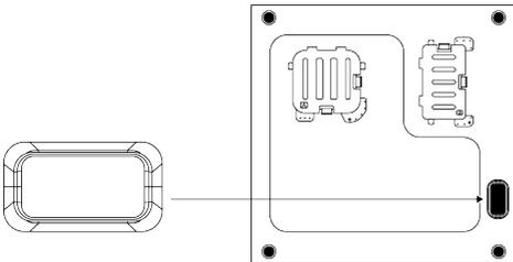
Setzen Sie die Kappe ein, indem Sie sie mit dem Finger drücken.
