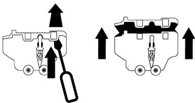
7. Le guide che tengono il coperchio superiore del cassetto del detersivo vengono rimosse con un cacciavite a testa piatta (ci sono in totale 6 guide, due ciascuna a destra, a sinistra e sul retro del cassetto) e si lava l'interno del cassetto.
