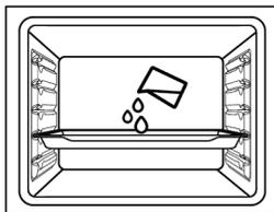
3. Réglez le four sur le mode de fonctionnement "Chauffage par le bas" et faites-le fonctionner à 100°C pendant 20 minutes.
