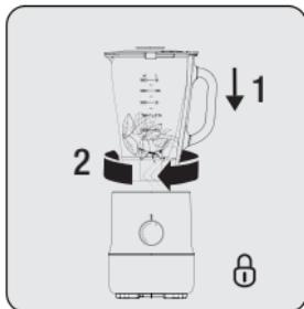
Umieść szklany pojemnik (3) pionowo w module napędowym (6) i obrócić w kierunku symbolu „ $\theta$ ”, aby go zablokować.
