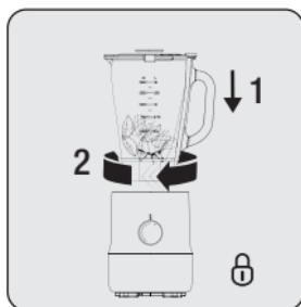
Așezați recipientul din sticlă (3) în poziție verticală pe unitatea motorizată (6) rotiți-l spre simbolul “ $\theta$ ” pentru a-l bloca în poziție.
