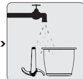
Odlacz urządzenie od prądu. Najpierw zdejmij moduł napędowy (4), pokrywę (3), a następnie ostrza (6).
