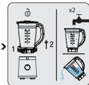
Odstranite stekleno posodo (3) iz pogonske enote (6). Sperite z vodo, da očistite večje ostanke hrane, ki ostanejo na posodi.
