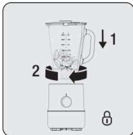
Stellen Sie den Glasbehälter (3) aufrecht auf die Motoreinheit (6) und drehen Sie ihn auf das Symbol „“, um ihn zu verriegeln.
