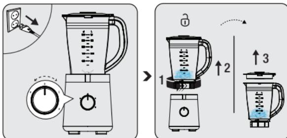
Al termine della miscelazione, ruotare la manopola di regolazione della velocità (7) fino a portarla in posizione "0", quindi togliere la spina dalla presa.
