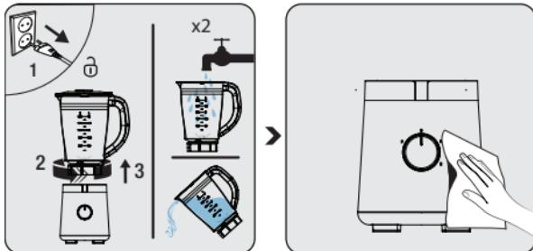
Odlacz urządzenie od prądu. Wyjmij szklany pojemnik (3) z modułu napędowego (6) i przepłucz wodą. W razie potrzeby powtóż.
