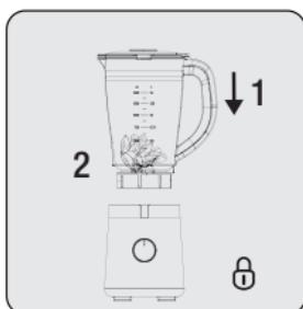
Skleněnou nádobu (3) postavte na jednotku motoru (6) ve svislé poloze, otočte ji na symbol " $\oplus$ ", pro její zajištění na její místo.
