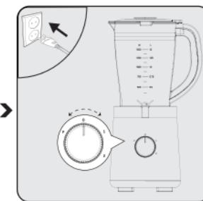
Ukopčajte uređaj u utičnicu i počnite sa radom biranjem nivoa brzine (7).
