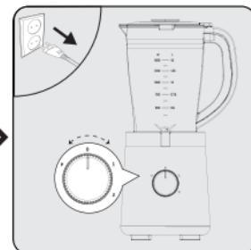
Al termine della miscelazione, ruotare la manopola di regolazione della velocità (7) fino a portarla in posizione “0”, quindi togliere la spina dalla presa.
