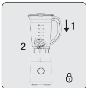
Mettere il contenitore in vetro (3) sull'unità motore (6) in verticale, ruotarlo fino a portarlo sul simbolo “” per bloccarlo in posizione.
