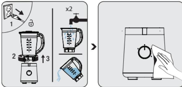
انزع الجهاز من الكهرباء. انزع الحاوية الرّجاجية (3) من على وحدة المحرك (6)، واشطفها بالماء. كرر نفس الخطوات حسب الحاجة.
