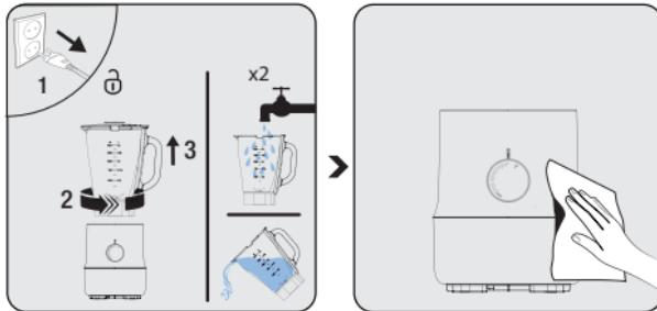
Ziehen Sie den Gerätenetzstecker. Nehmen Sie den Glasbehälter (3) aus der Motoreinheit (6) und spülen Sie ihn mit Wasser aus. Wiederholen Sie gegebenenfalls die gleichen Schritte.
