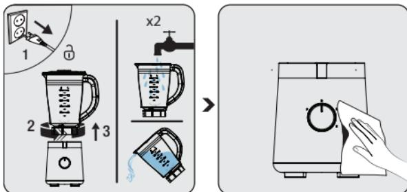
Выключите изделие из розетки. Снимите стеклянный контейнер (3) с блока двигателя (6) и промойте его водой. При необходимости повторите те же действия.
