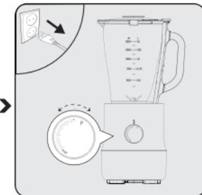
Wenn das Mischen beendet ist, drehen Sie den Geschwindigkeitsregler (7) auf die Position „0“ und ziehen Sie den Stecker aus der Steckdose.
