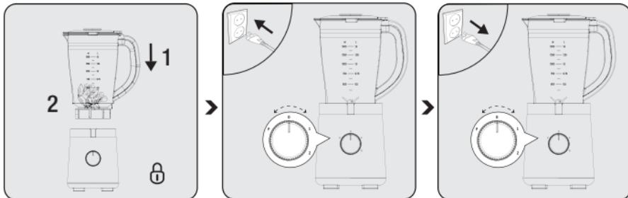
Așezați recipientul din sticlă (3) în poziție verticală pe unitatea motorizată (6) rotiți-l spre simbolul “ $\theta$ ” pentru a-l bloca în poziție.
