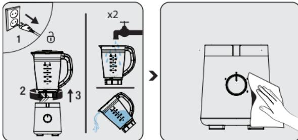
Deconectați aparatul de la sursa de alimentare. Îndepărtați recipientul din sticlă (3) de pe unitatea motorizată (6) și clătiți-l cu apă. Dacă este necesar repetați aceeași pași.
