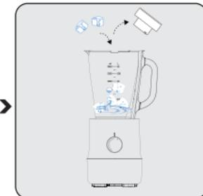
Um während des Betriebs mehr Eis hinzuzufügen, öffnen Sie die Messkappe (1) und fügen Sie Eiswürfel hinzu.
