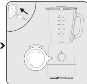
Stecken Sie das Gerät in die Steckdose und starten Sie den Betrieb, indem Sie die Geschwindigkeitsstufe (7) wählen.
