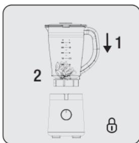
Stakleni spremnik (3) namestite uspravno na jedinicu motora (6), okrenite je prema oznaci "↑" i blokirajte u odgovarajućem položaju.
