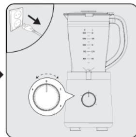
Ko je mešanje končano, zavrite gumb za nastavitev hitrosti (7) v položaj "0" in izključite napravo iz vtičnice.
