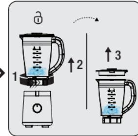
Pokud chcete odebrat skleněnou nádobu (3) z motorové jednotky (6), otočte ji na symbol " $\partial$ " a vyberte ji. Nádobu (3) postavte na rovný povrch a otevřete ji otočením a zvednutím víka (2) ve směru hodinových ručiček.
