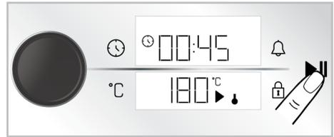
⇒ Il forno inizia a funzionare immediatamente alla funzione e alla temperatura selezionate e sul display appare il conto alla rovescia per la cottura. Sul display della temperatura sono mostrati i simboli ↓ e ▶. Quando la temperatura all'interno del forno raggiunge la temperatura impostata, si illuminerà ogni fase del simbolo ↓. Al termine del tempo di cottura impostato, appare la dicitura "End" sul display della temperatura, il timer emette un segnale acustico e la cottura si ferma.
