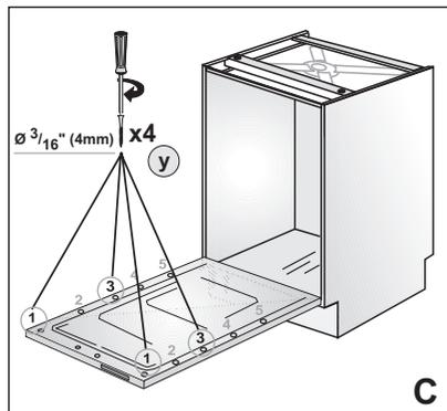
10. Serrez complètement les vis des emplacements 1 et 3 après l'alignement final (illustration C).
