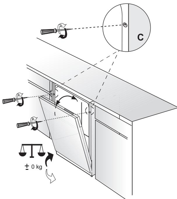
Vérifiez la tension de la porte du lave-vaisselle. Si la porte se ferme trop vite ou si la porte tombe en position ouverte, le ressort tenseur doit être réglé. Les vis de réglage se trouvent sur le devant du lave-vaisselle, une fois la porte ouverte (cf. l'illustration). Réglez le ressort tenseur en tournant la vis vers la droite pour augmenter le poids ou vers la gauche pour diminuer le poids (illustration C).
