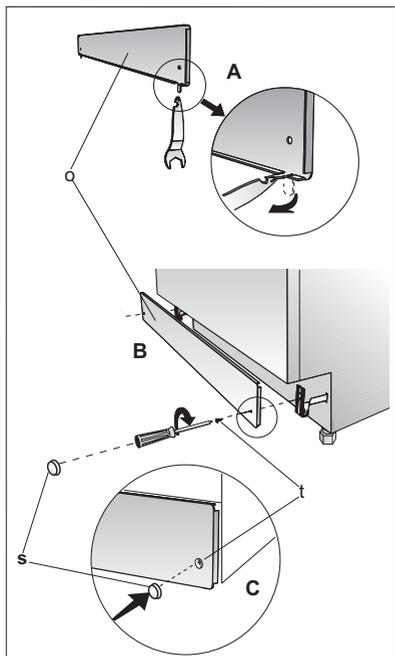
Verrouillez les équerres de la plinthe avec le taquet en plastique, comme dans l'illustration C, en poussant le taquet en plastique sur le lave-vaisselle dans les dents de l'équerre (C).
