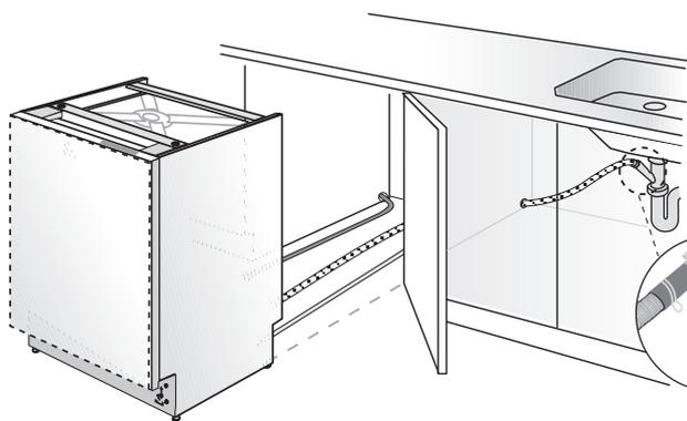
Remarquez que les marques sur le tuyau de connexion en caoutchouc doivent être sur le côté du tuyau d'évacuation.
