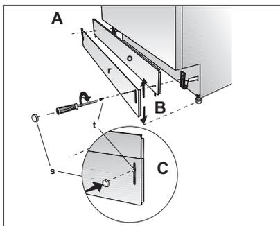
Si la hauteur de la zone d'encastrement est supérieure à  $341/4''$  (870 mm), utilisez les plinthes "o" et "r" ensemble. Assurez-vous que la plinthe munie d'encoches (r) soit à l'extérieur pour que vous puissiez régler la hauteur de la plinthe. L'installation doit être réalisée en suivant les étapes illustrés A, B et C respectivement.
