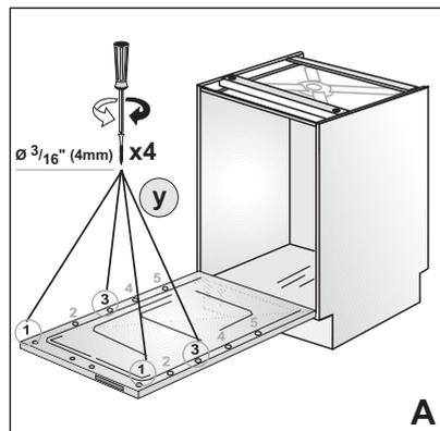
8. À l'aide des quatre vis de  $\text{Ø } 3/16'' \times 111/16''$  ( $\text{Ø } 4 \text{ mm} \times 43 \text{ mm}$ ) fournies, fixez la porte en bois au lave-vaisselle aux emplacements 1 et 3 (illustration A).
