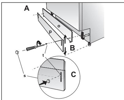
Si la hauteur de la zone d'encastrement est supérieure à  $331/16''$  (840 mm), utilisez les plinthes "o" et "p" ensemble. Assurez-vous que la plinthe munie d'encoches (p) soit à l'extérieur pour que vous puissiez régler la hauteur de la plinthe. L'installation doit être réalisée en suivant les étapes illustrés A, B et C respectivement.
