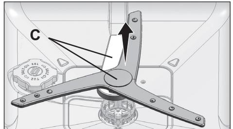
Para retirar y limpiar el conjunto del impulsor inferior, sosténgalo con una mano de los puntos (C) mostrados en la figura y tire hacia arriba para retirarlo. Después de la limpieza, siga estos pasos en orden inverso para reinstalar el conjunto del impulsor.
