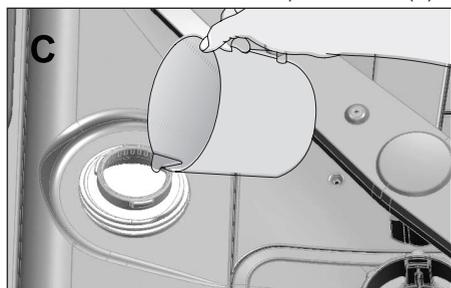
4. Vierta sal en el compartimento de sal con la ayuda del embudo (D). Para acelerar la disolución de la sal en el agua, remuévala con una cuchara.
