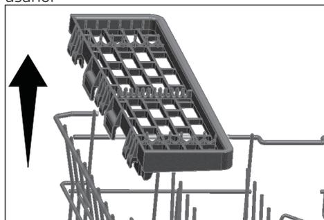
Si desea volver a utilizar la rejilla del canasto del estante de servicio multipropósito, puede engancharlo fácilmente en la sección lateral del canasto superior.
