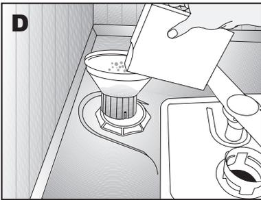
4. Introduzca sal en el dispensador con ayuda del embudo provisto (Fig. D). Introduzca suficiente sal para llenar el dispensador. El dispensador tiene capacidad aproximadamente para 2 kg (4,4 libras).
