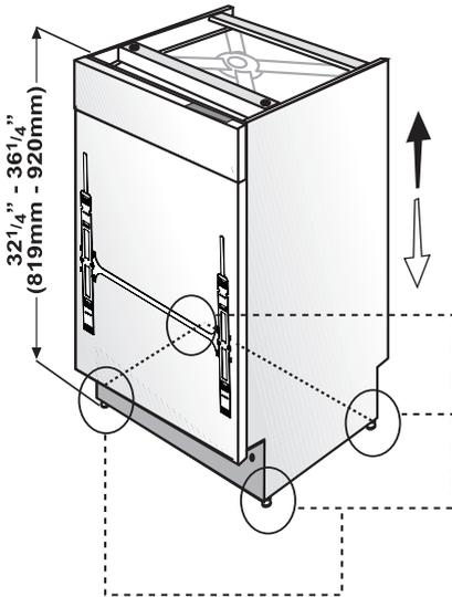
Si la altura del recinto es superior a los  $34\frac{1}{4}''$  (870 mm), retire el soporte corto y use soportes largos tal como se muestra en la figura.
