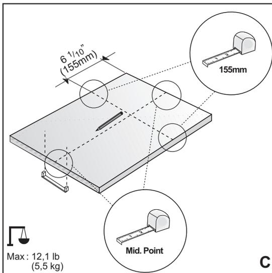
3. Marque la puerta de madera, tal como se muestra en el dibujo (Figura **C**).
