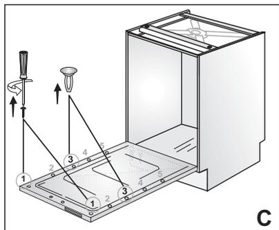
7. Abra la puerta y quite las dos lengüetas y los dos tornillos dentro de la puerta en posición 1 y 3 (Figura C).
