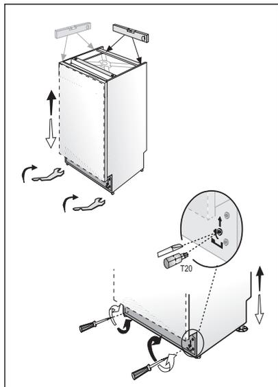
Ajuste el nivel inferior frontal con la llave de ajuste para equilibrar y elevar el lavavajillas hasta la altura del gabinete.
