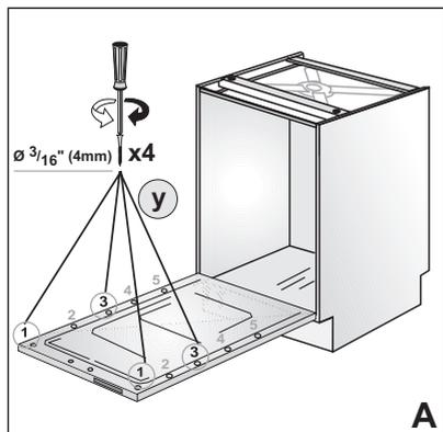
8. Utilizando los cuatro tornillos  $\text{Ø } 3/16'' \times 111/16''$  ( $\text{Ø } 4 \text{ mm} \times 43 \text{ mm}$ ) provistos, fije la puerta de madera al lavavajillas en la posición 1 y 3 (Figura A).
