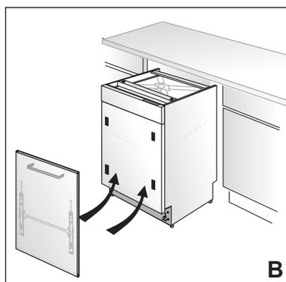
6. Instale la puerta de madera en el lavavajillas con las abrazaderas de montaje plásticas que se han fijado (Figura **B**).
