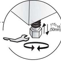
Si la altura del recinto es de entre  $33\frac{7}{16}''$  y  $34\frac{1}{4}''$  (850 mm a 870 mm), ajuste los soportes de la manera que se muestra en la figura.
