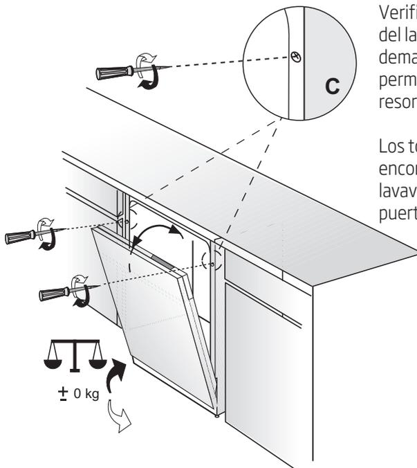
Verifique la tensión de la puerta del lavavajillas: Si la puerta se cierra demasiado rápido o si la puerta permanece abierta, la tensión del resorte necesita ajustarse.
