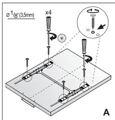
5. Fije las dos abrazaderas de montaje a la puerta de madera con 4 tornillos ( $\text{Ø } 1/8'' \times 5/8''$ ) ( $\text{Ø } 3.5 \text{ mm} \times 14 \text{ mm}$ ) (Figura **A**).
