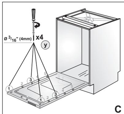
10. Ajuste completamente los tornillos en la posición 1 y 3 después de la alineación final (Figura C).
