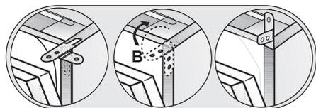
Coloque las dos abrazaderas de montaje sobre las esquinas superiores del lavavajillas. Doble los lados de las abrazaderas de montaje (A) para ajustarlas de los lados (si es necesario)
