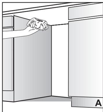
La lámina de protección de vapor se aplicará en el lugar donde se escapa el vapor caliente la primera vez que abra la puerta (como se muestra en la figura B).
