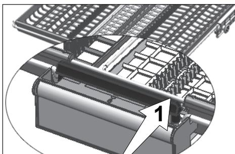
En modelos con la característica de movimiento parcial, presionando la barra (1) en el asa permite que la bandeja central de la canasta acceda a la posición inferior y el sistema se desbloquee. Así se pueden utilizarse las bandejas laterales derechas e izquierdas como partes móviles. El espacio libre habilitado por las bandejas laterales permite la carga de piezas largas en la cesta superior.
