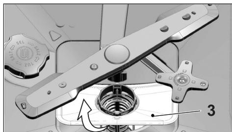
3. Pulse los dos trinquetes del filtro grueso hacia adentro y separe el filtro grueso del montaje.
