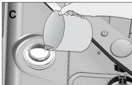
4. Remplissez le réservoir de sel en utilisant l'entonnoir à sel (D). Pour accélérer la dissolution du sel dans l'eau, remuez-le à l'aide d'une cuillère.
