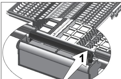
Dans les modèles avec fonction de mouvement partiel, lorsque vous poussez la barre (1) sur la poignée, le plateau central du panier passe à la position inférieure et le système se déverrouille. Ainsi, les plateaux à droite et à gauche peuvent être utilisés comme pièces mobiles. L'espace libre laissé par les plateaux latéraux permet de charger les pièces longues dans le panier supérieur.
