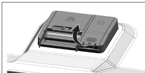
2. Remplissez le réservoir jusqu'au niveau « MAX ».
