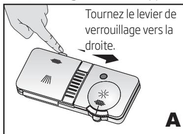
1. Ouvrez le réservoir de détergent en poussant le levier de verrouillage vers la droite **A**.
