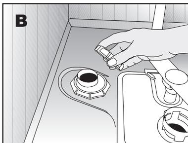
2. Ouvrez le couvercle vissé du compartiment à sel en le tournant dans le sens anti-horaire (illustration. **A, B**).
