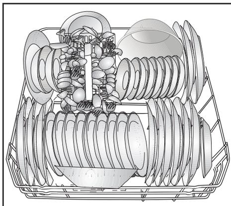
Schéma de chargement du panier du bas pour un service de 12 couverts conforme à la norme AHAM DW-1
