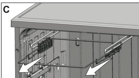
Remplacez les cache-rails et appuyez dessus pour les remettre correctement en place. Tournez les rails vers les côtés de l'appareil pour les remettre correctement en place (D).
