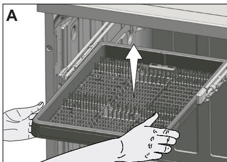
Si vous ne souhaitez pas utiliser le panier à couverts supérieur, tirez-le vers vous pour le retirer de l'appareil, faites pivoter les cache-rails vers l'extérieur et tirez-les vers vous pour les retirer (B).
