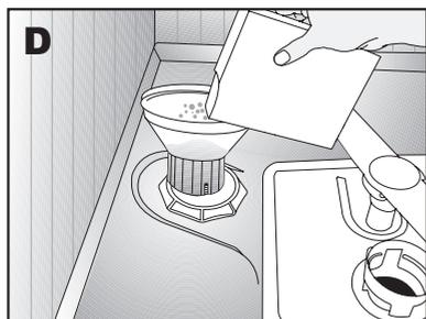
4. Versez le sel dans le compartiment à l'aide de l'entonnoir à sel fourni (illustration. **D**). Versez suffisamment de sel pour remplir le compartiment. Le compartiment a une contenance d'environ 2 kilos / 4,4 livres.
