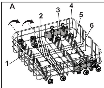
Pour ramener les fils pliants ne position horizontale, attrapez les fils du milieu et poussez-les dans la direction des flèches (B) Pour ramener les fils en position verticale, vous avez seulement à les resoulever. Les fils pliants recliperont dans le loquet.
