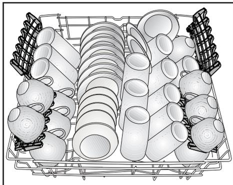
Schéma de chargement du panier du haut pour un service de 12 couverts conforme à la norme AHAM DW-1
