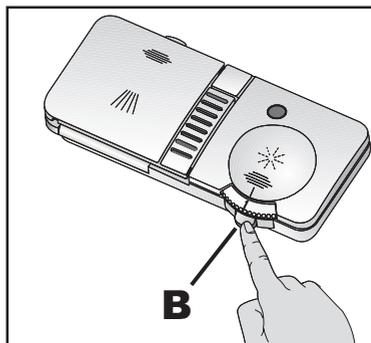
1. Ouvrez le couvercle du réservoir de produit de rinçage en poussant le levier de verrouillage **B**.
