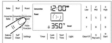
El calor superior e inferior está encendidos. El calor proviene de la parte superior e inferior y se hace circular a través del horno por un ventilador de convección. El modo de asado se puede utilizar para carnes, aves y grandes cantidades de alimentos asados.
