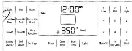
Solamente está encendido el calentador inferior. El modo de horneado se puede utilizar para una variedad de alimentos, desde tortas a guisos.
