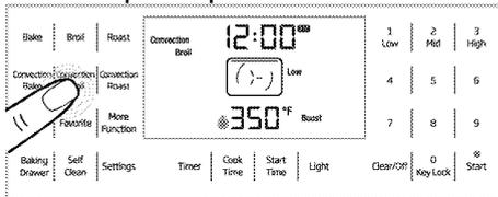
La fuente de calor superior está encendida. El calor proviene de la parte superior y se hace circular a través del horno por un ventilador de convección. Puede utilizarse para asar carne, aves y pescados a la parrilla. La comida debe ser puesta en la parrilla en una cacerola (bandeja para asar).
