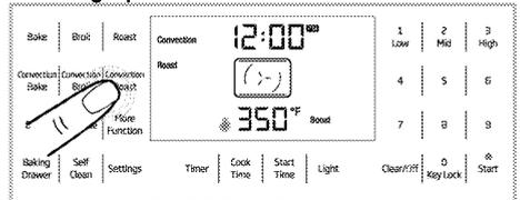
Les éléments chauffants supérieur et inférieur sont activés. La chaleur provient des parties supérieure et inférieure du four et est répartie
