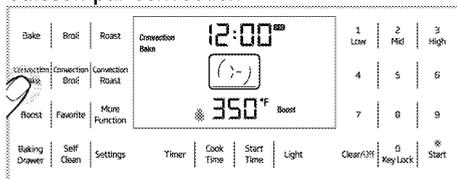
Seul l'anneau de chauffage est activé. La chaleur provient de l'arrière de la plaque d'acier et est répartie dans le four grâce au ventilateur à convection. Vous pouvez utiliser le mode Cuisson par convection pour divers types d'aliments, de la pâtisserie aux pains.
