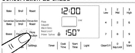
Seul l'élément chauffant inférieur est activé. Le mode Conservation au chaud va conserver les aliments cuits chauds à une température de service. Commencez toujours à servir les repas chauds. Les aliments froids ou à la température ambiante ne peuvent pas être réchauffés dans ce mode (excepté les crackers, chips, ou céréales sèches croustillants). Les bactéries vont se développer très rapidement dans les aliments dont la température est située entre 40 °F (4,5 °C) et 140 °F (60 °C).
