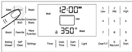
Seul l'élément chauffant du haut est activé. Le mode Gril peut être utilisé pour les morceaux de viandes, volailles et poissons. Il peut aussi être utilisé pour dorer le pain. Mettez les aliments sur une grille ou dans un poêle (plaque à griller).
