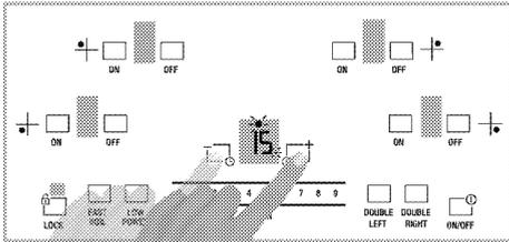
» La hora de la alarma se confirmará en 10 segundos. La hora de alarma ajustada aparecerá en la pantalla y la luz de advertencia superior parpadeará. Al final de la hora de alarma, se emitirá un sonido de señal acústica. Pulse cualquier tecla para detener el sonido de la señal acústica.
