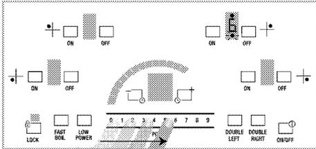
» El nivel de temperatura se confirmará en 10 segundos y la luz de advertencia inferior se encenderá. Las secciones interior y exterior de la zona de cocción seleccionada se activarán simultáneamente a la temperatura establecida. Si toca la tecla "ON" de otra zona de cocción antes de diez segundos, el ajuste se confirmará inmediatamente.
