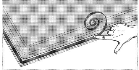
4. Inserte la placa de cocina centrada en la abertura del recorte. Asegúrese de que el borde frontal de la encimera esté paralelo a la placa de cocina. Haga una comprobación final de que se cumplen todas las autorizaciones requeridas.
