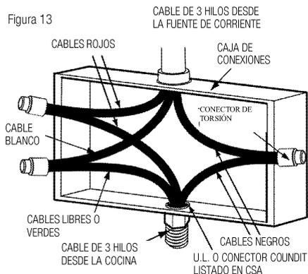
En los casos en que los códigos locales permiten conectar el conductor de la estructura a tierra al cable neutro (blanco) de caja de conexiones. (No se aplica para las instalaciones Canadienses)
