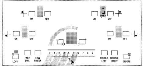
» El nivel de temperatura se confirmará en 10 segundos y la luz de advertencia inferior se encenderá. La zona de cocción correspondiente comenzará a funcionar con el nivel de temperatura ajustado. Si toca la tecla "ON" de otra zona de cocción antes de diez segundos, el ajuste se confirmará inmediatamente. También puede operar otras zonas de cocción siguiendo los mismos pasos y ajustando los niveles de temperatura.
