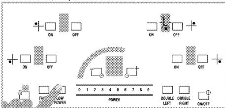
"El ajuste se confirmará en 10 segundos y la luz de advertencia inferior se encenderá." En la pantalla de la zona de cocción correspondiente aparecerá el nivel de temperatura ajustado y "L" respectivamente. La zona de cocción seguirá funcionando durante un período de tiempo más corto.
