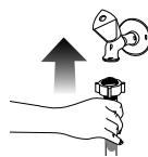
1. Барлық гайкаларды қолмен тартыңыз. Гайкаларды тарту үшін гайка кілтін пайдаланбаңыз.
